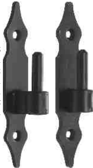
8982/28 Ladenkloben Eisen schwarz verzinkt 150x30x4 mm Bolzen-Ø: 10 mm Mitte Bolzen bis Auflagefläche Holz: 28 mm
