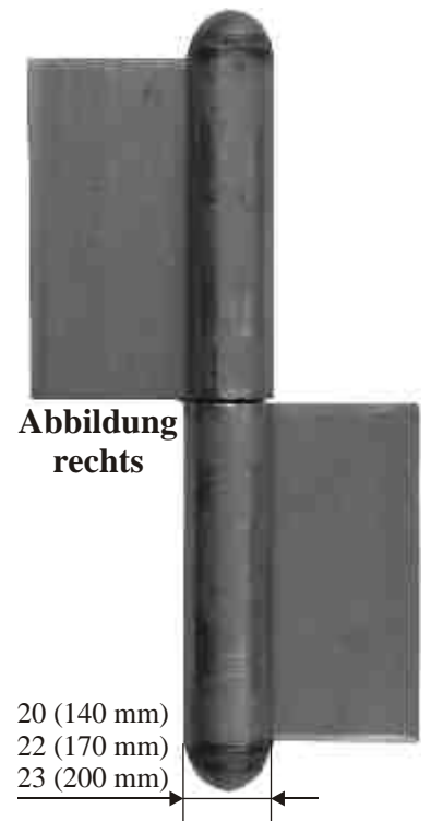
8988/140 mm Rollenlänge 8988/170 mm Rollenlänge 8988/200 mm Rollenlänge sehr schweres Fischband Eisen blank Blechstärke: 4 mm rechts oder links lieferbar Bitte angeben!
