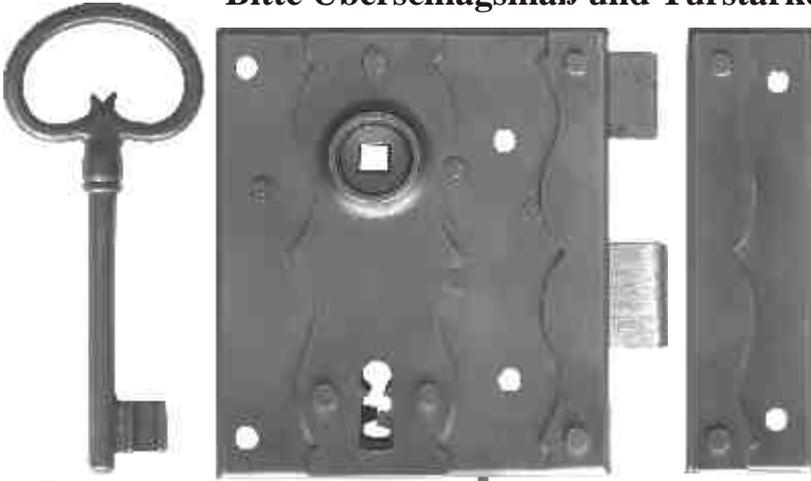
**8786** Eisen blank, mit schießender Falle, Schließkasten und Schlüssel. Drückerpaar nach Ihrer Wahl dazu bestellen. BB oder PZ-vorgerichtet. Dornmaß 60 mm. Kasten: BxH: 100x115 mm
