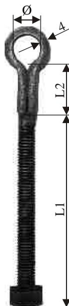
Mit metrischem Gewinde zum Durchschrauben, inclusive Unterlegscheibe und Vierkantmutter
